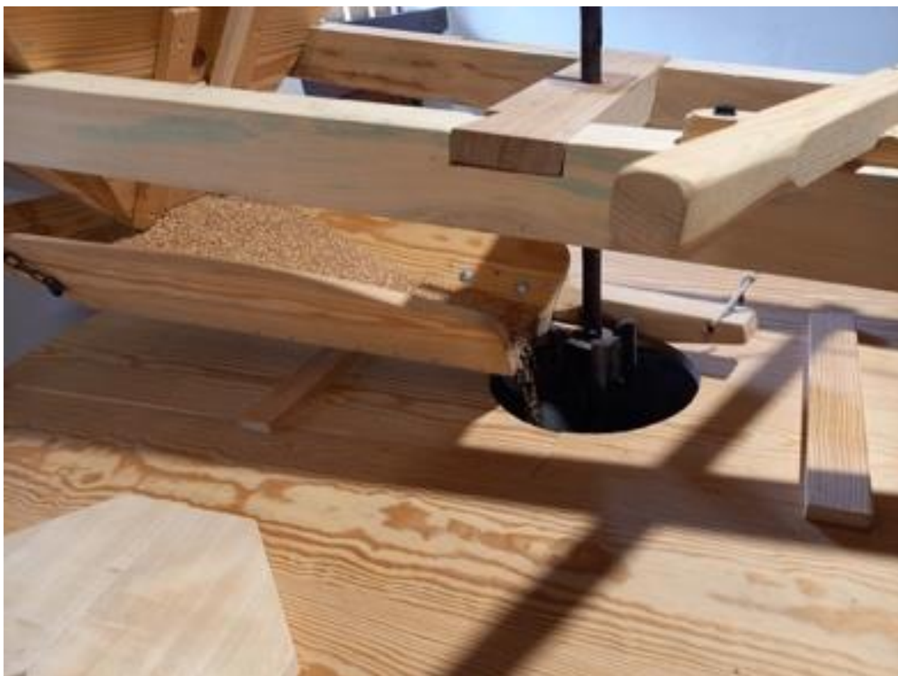
De schuddebak strooit de graankorrels in kropgat.
